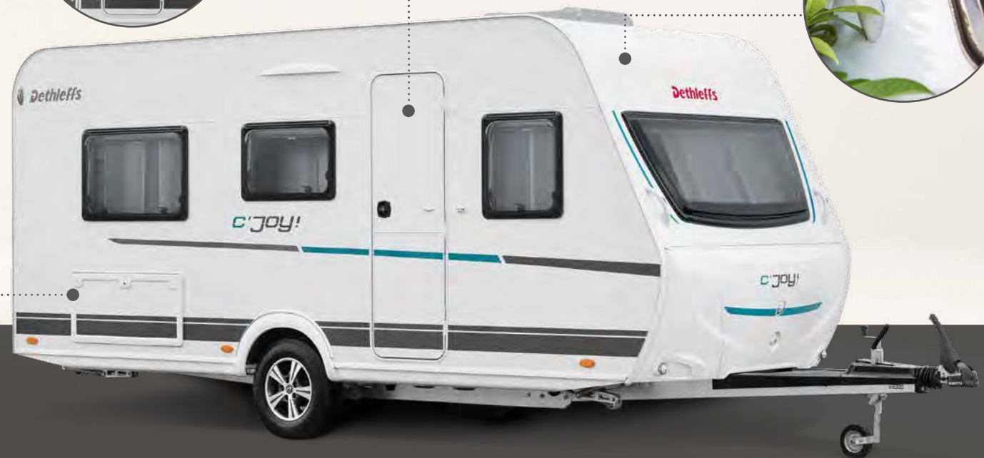
De voor- en achterzijde en het dak zijn gemaakt van hagelbestendig GFK-materiaal
