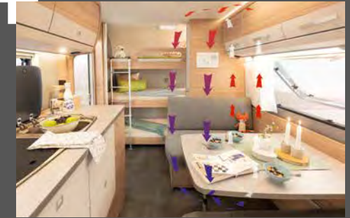
AirPlus – perfecte luchtcirculatie in het interieur en ventilatie aan de achterkant van bovenkasten en aanrecht
