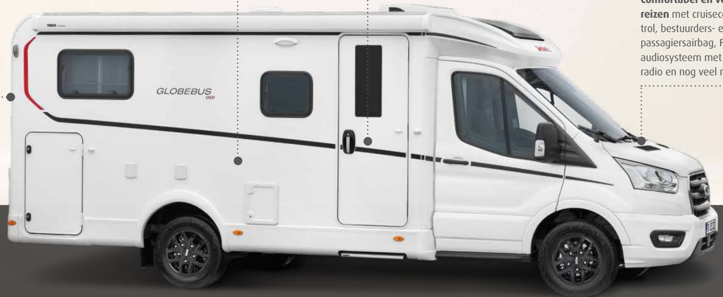
Dak, achterzijde en zijwanden van sterk GFK-materiaal.
