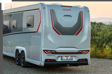
Automotive gevormde GFK-achterzijde met de beste isolatie en elegante integratie van achteruitrijcamera en derde remlicht
