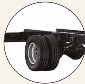
Achterwielaandrijving met dubbele wielen en luchtvering van de aandrijfassen
